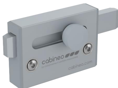
Verrou standard cabine : pêne coulissant alu + boîtier de voyant libre-occupé faisant prise de main – décondamnation par clé carrée
